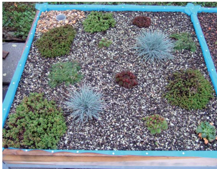
Testování střešních substrátů
